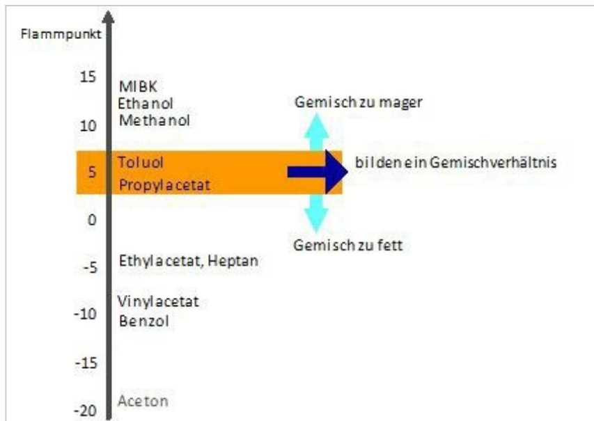
Abbildung 2: Das sich oberhalb einer entflammaren Flüssigkeit ausbildende Gemischverhältnis wird maßgebend vom Flammpunkt (FP) bestimmt. Die Flammpunkte von Toluol und Propylacetat liegen beide bei 5°C. Beide Flüssigkeiten lassen sich optimal durch elektrostatische Aufladung zünden. (Bild: Elstatik)
